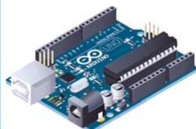
C'est une carte électronique programmable sur laquelle nous pouvons brancher des capteurs et des moteurs.
