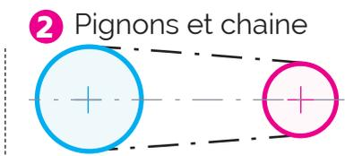
C'est un système constitué de deux pignons (Roues dentées) et d'un élément intermédiaire articulé appelé chaîne.
