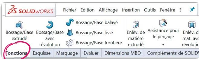
Une fois l'esquisse terminée, on peut créer un modèle 3D en utilisant des fonctions telles que l'extrusion et la révolution.
