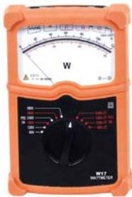
Le wattmètre est un appareil qui mesure la puissance électrique consommée par un récepteur ou fournie par un générateur électrique.
