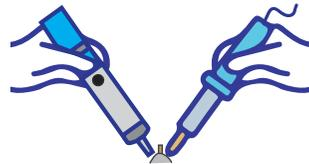
Appliquer le bout de la pompe à dessouder sur la soudure fondue **sans appuyer**.
